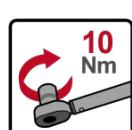
Monteres med EPDM-pakning, mutter M10 og skive. Tildragningsmoment 10 Nm.
